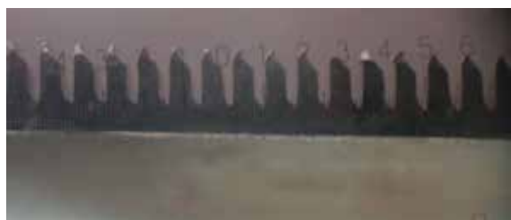
Рис.2. Нержавеющая труба, оребренная методом деформирующего резания (технология МГТУ)
