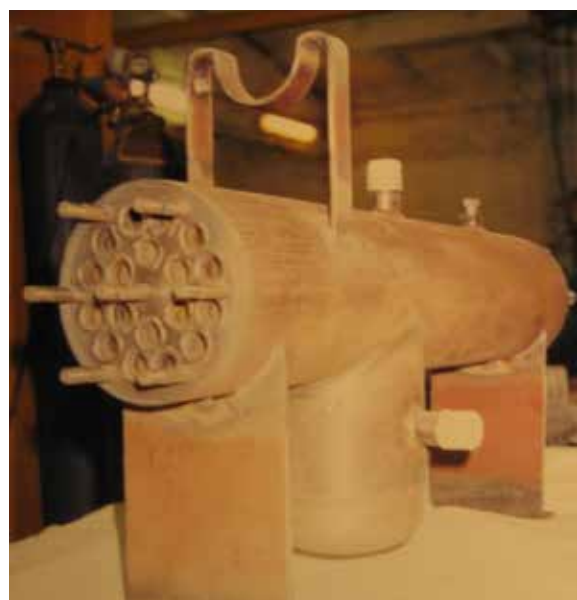
Рис.3. Опытно-промышленный нержавеющий конденсатор – аналог конденсатора ККТ1-2,2
