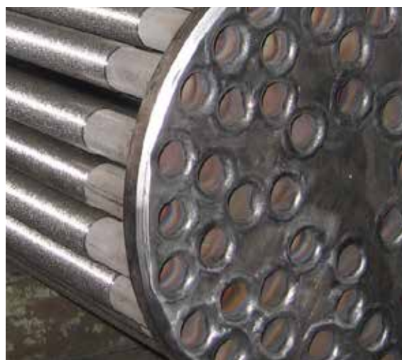
Рис.5. Нержавеющий аналог конденсатора ККТ1-7,0. Трубный пучок. Аргонно-дуговая сварка
