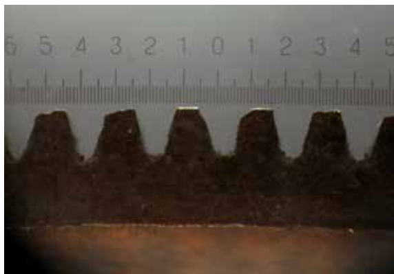
Рис.1. Медная труба, оребренная накаткой по винтовой линии (технология ВНИИМетмаш)
