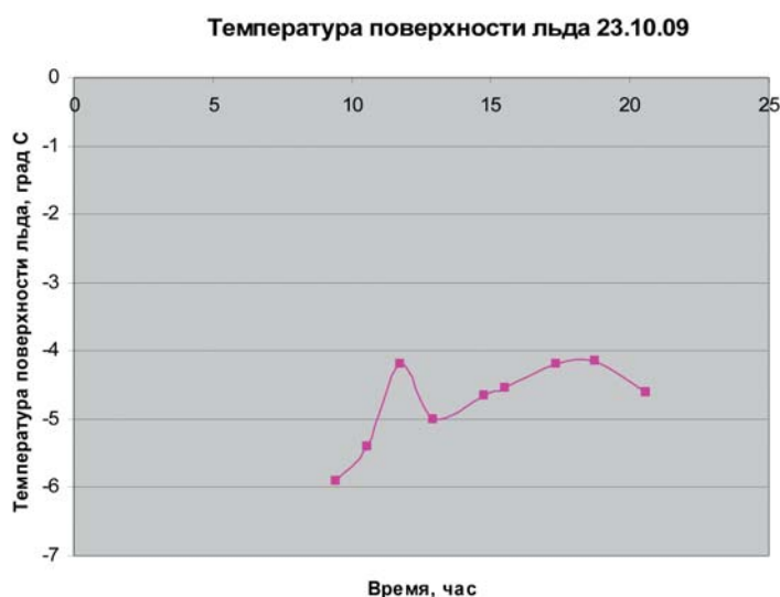
Рис. 2. Данные замеров температуры поверхности массива льда в течение одного дня соревнований
