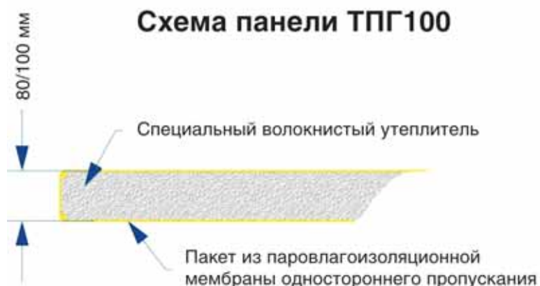
Рис. 4, 5. Схема ограждающей конструкции тентового сооружения с установленной термопанелью
