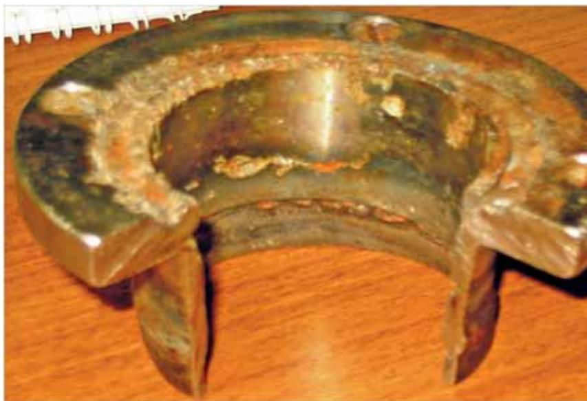
Рис. 3. Фото коррозии фланца из нержавеющей стали
