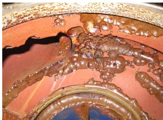
Рис. 1г. Кавитационная эрозия поверхности улитки насоса
