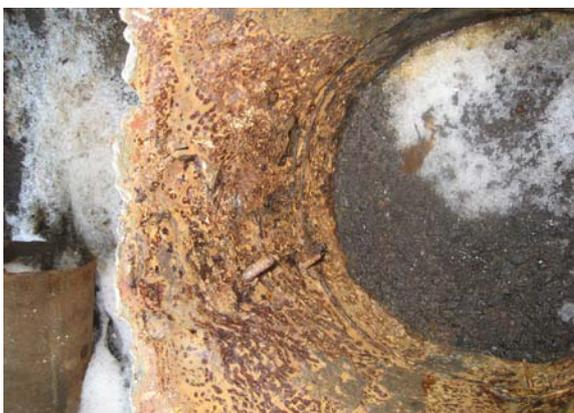
**Рис. 1б.** Язвенная и питинговая коррозия трубопроводов системы
