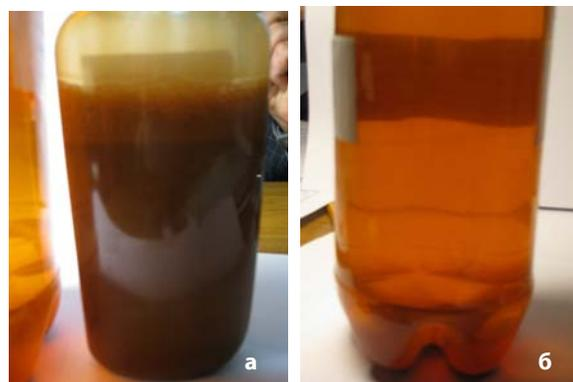
Рис. 3 а. Образец хладоносителя до регенерации, б. Образец хладоносителя после регенерации.
