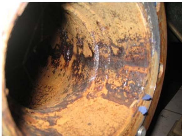
**Рис. 1а.** Абразивный износ участка трубопровода вторичного контура
