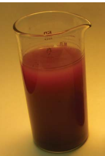
Рис. 1. Образец хладоносителя (30% водный раствор пропиленгликоля без ингибиторов коррозии) пивоваренного завода после 3 лет эксплуатации
