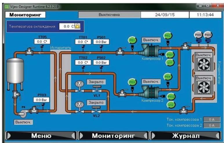
Рис. 1: Мнемосхема чиллера с гидромодулем на панели GXO.
