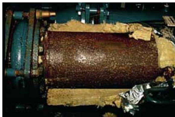
**Рис. 4.** Поверхностная коррозия оборудования под слоем изоляции из минераловатных плит.
