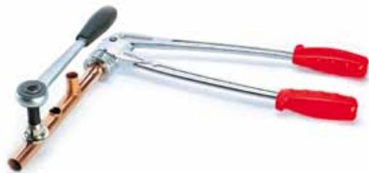
ра должна составлять 0,025-0,125 мм, и, благодаря винту точной регулировки, каждый может настроить инструмент, как говорится, «под себя».
