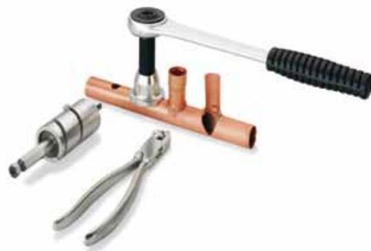
Подготовка вставляемой трубы заключается в нанесении специальными клещами ограничительных рисок, препятствующих чрезмерному заглублению трубы в горловину. Разумеется, медные окислы на соединяемых трубах необходимо тщательно удалить.
